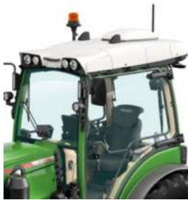
De Fendt Guide-ontvanger is beschermd en geïntegreerd in de dakconstructie aangebracht.
