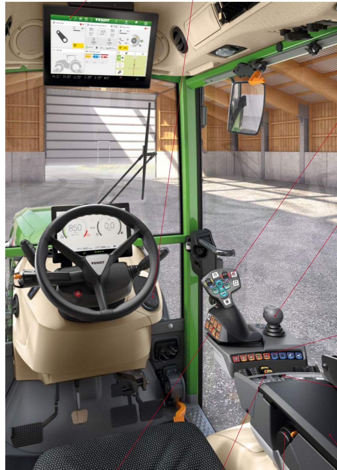
Hier regelt u de vertrouwde transmissie- en rijfuncties comfortabel door middel van druktoetsen: daartoe behoren 2 motortoerentalgeheugens, 2 cruisesnelheden en een nieuwe, actieve cruisecontrol-instelling met een draaiknop.
